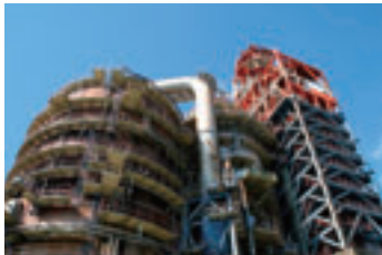
京浜製油所水江工場の重質油熱分解装置（フレキシコーカー）
