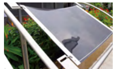
2015年6月に、シンガポールの新しい物流ターミナルビルに試験的に設置したベンダブル・モジュールの試作品
